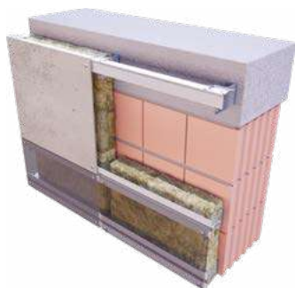
Sistema con orditura orizzontale
